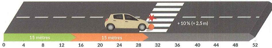
À 50 km/h, avec des amortisseurs ne contenant plus que **50%** de leur capacité en huile, il faut **30 m** à un véhicule pour s'arrêter, soit 2,5 m (+10%) de plus qu'avec des amortisseurs en bon état.
