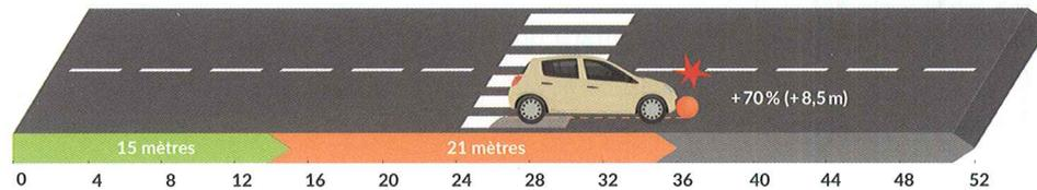
À 50 km/h, avec des amortisseurs ne contenant plus que **25%** de leur capacité en huile, il faut **36 m** à un véhicule pour s'arrêter, soit 8,5 m (+70%) de plus qu'avec des amortisseurs en bon état.
