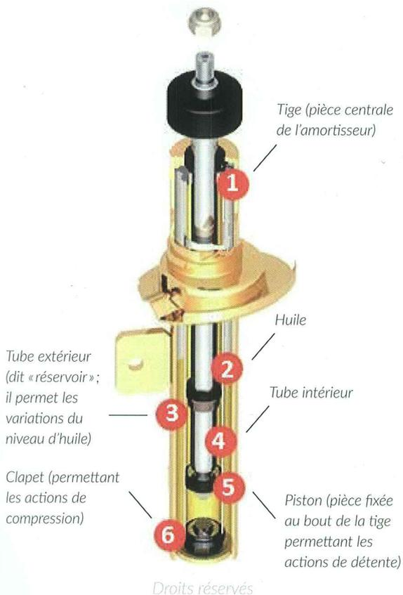
Quand le véhicule roule, le ressort se comprime et met en mouvement la tige et le piston à l'intérieur du cylindre rempli d'huile. Ce piston fait alors pression sur l'huile qui est chassée du tube intérieur, via le clapet, dans le tube extérieur.
