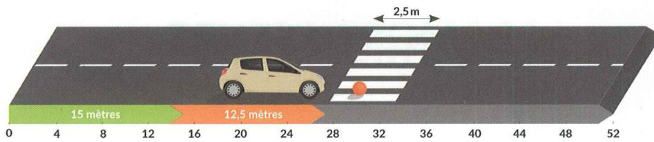
À 50 km/h, avec des amortisseurs en **bon état** de fonctionnement, il faut **27,5 m** à un véhicule pour s'arrêter.
