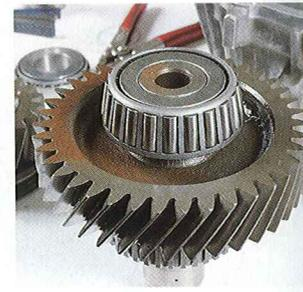
**52** | Sur l'arbre intermédiaire, poser le roulement conique.
