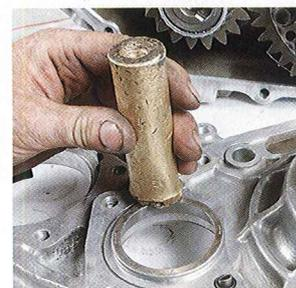
62 | Installer les deux cages de roulement conique.
