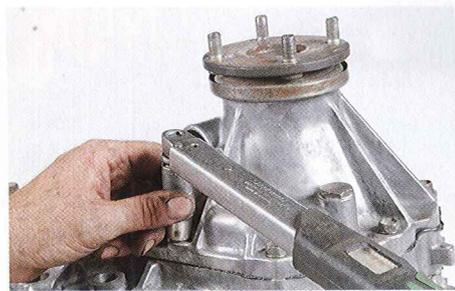
**71** | Joindre et remonter le carter arrière. Serrage à 37 Nm.
