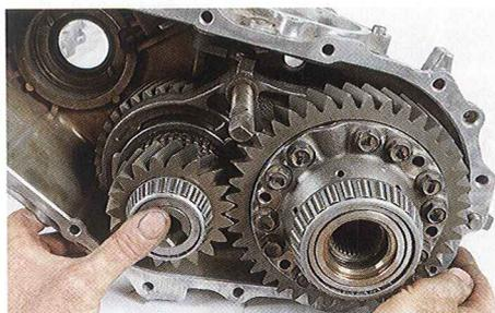
57 | Installer l'ensemble dans le carter en installant le bras de sélection au milieu de la fourchette.
