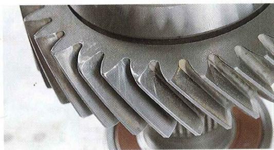
**50** | Malheureusement, par accident, notre arbre secondaire se retrouve au sol. La cémentation a sauté sur deux dents en dehors de la zone de contact. Un passage à la toile émeri corrigera ce défaut.
