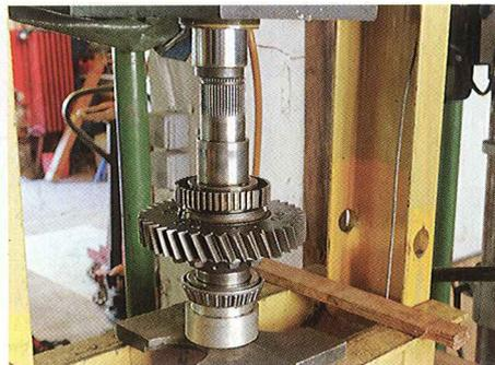
**35** | À la presse, monter le roulement conique arrière.
