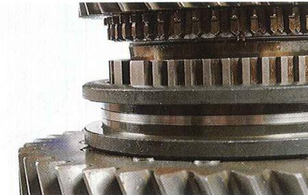
**36** | Positionner les ressorts de clavettes et installer le moyeu d'embrayage sur son manchon. Partie chanfreinée vers l'avant, face à la bague de synchro.
