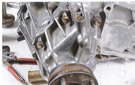
**76** | Placer les vis et les serrer à 37 Nm.
