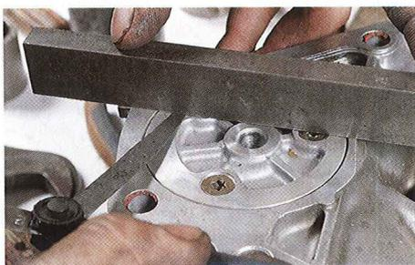
**70** | Mesurer la profondeur du carter de pompe à huile par rapport au plan de joint. En additionnant les deux mesures par rapport aux cales, on doit trouver entre 0,03 et 0,08 mm de jeu.
