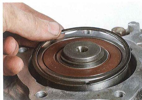
66 | Placer le circlips de blocage sur le roulement.
