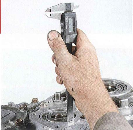
**69** | Vérifier la hauteur de la cage de roulement par rapport au plan de joint.
