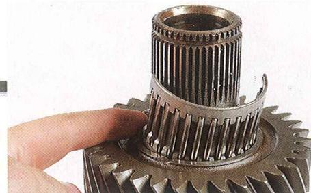
**37** | Positionner le pignon secondaire des grandes vitesses et installer le roulement à aiguille. Aligner les fentes avec les clavettes de changement de vitesse.
