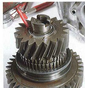
**54** | Reposer le pignon de première et installer le roulement à aiguille.
