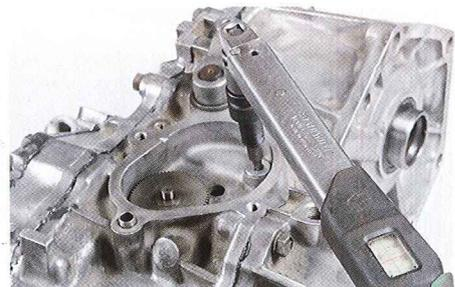
**79** | Serrer l'écrou à 19 Nm.
