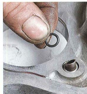
61 | Sur le carter secondaire, remplacer le joint torique du circuit d'huile.
