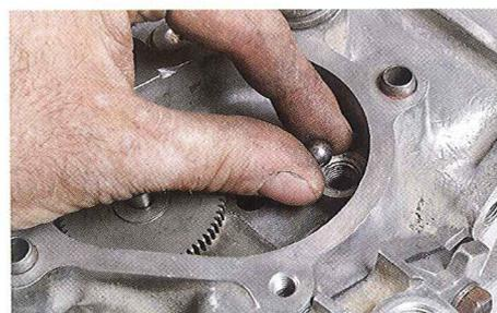
**78** | Installer la bille, son ressort et l'écrou de verrouillage.
