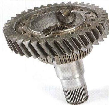
24 | Sur le différentiel, il va falloir vérifier le jeu de fonctionnement des pignons et satellites.
