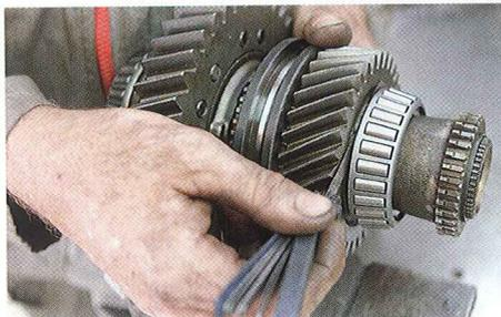
**40** | Vérifier le jeu latéral des pignons. Il doit être compris entre 0,10 et 0,25 mm. Des épaisseurs de jonc différentes (entre 1,8 et 2,8 mm) permettent le réglage de ce jeu.
