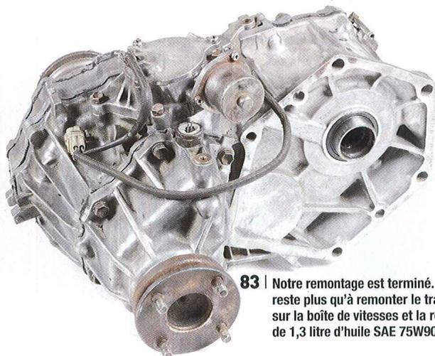
**83** | Notre remontage est terminé. Ne reste plus qu'à remonter le transfert sur la boîte de vitesses et la remplir de 1,3 litre d'huile SAE 75W90.
