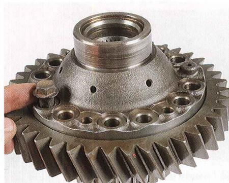
**33** | Serrer les boulons de différentiel à 88 Nm.
