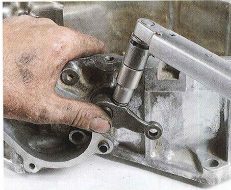
**44** | Reposer le bras de sélecteur avec sa rondelle. Serrer la vis du bras à 12 Nm.
