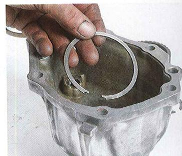
18 | Le bloquer avec le circlips.
