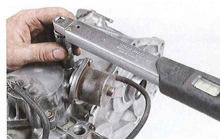
**80** | Monter le moteur de blocage. Le serrer à 19 Nm.
