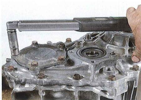
67 | Reposer le couvercle de carter après avoir mis de la pâte à joint. Serrage à 37 Nm.
